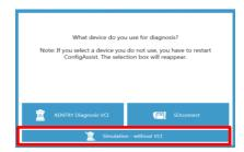
**Dopo il riavvio** si apre la presente finestra di selezione dell'hardware. Selezionare l'opzione "Simulazione – senza VCI" (Simulation – without VCI). Successivamente il tool ConfigAssist si apre automaticamente.
