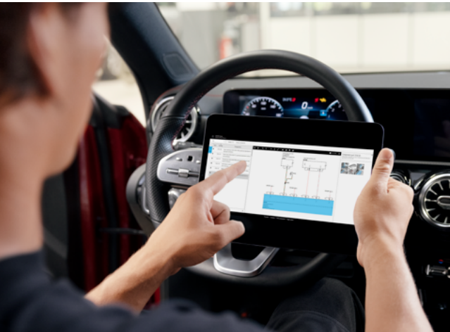
Información individualizada al instante: gracias a la representación de "Dynamic Wiring Diagram" específica para cada FIN, el usuario solo recibe el esquema de circuitos relevante para su vehículo.
