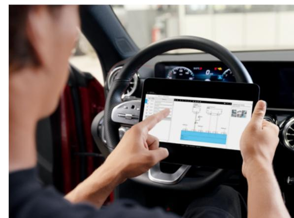
Informations sur mesure en seulement quelques secondes : la représentation spécifique au FIN du "Dynamic Wiring Diagram" affichée à l'utilisateur exclusivement le schéma correspondant à son véhicule.
